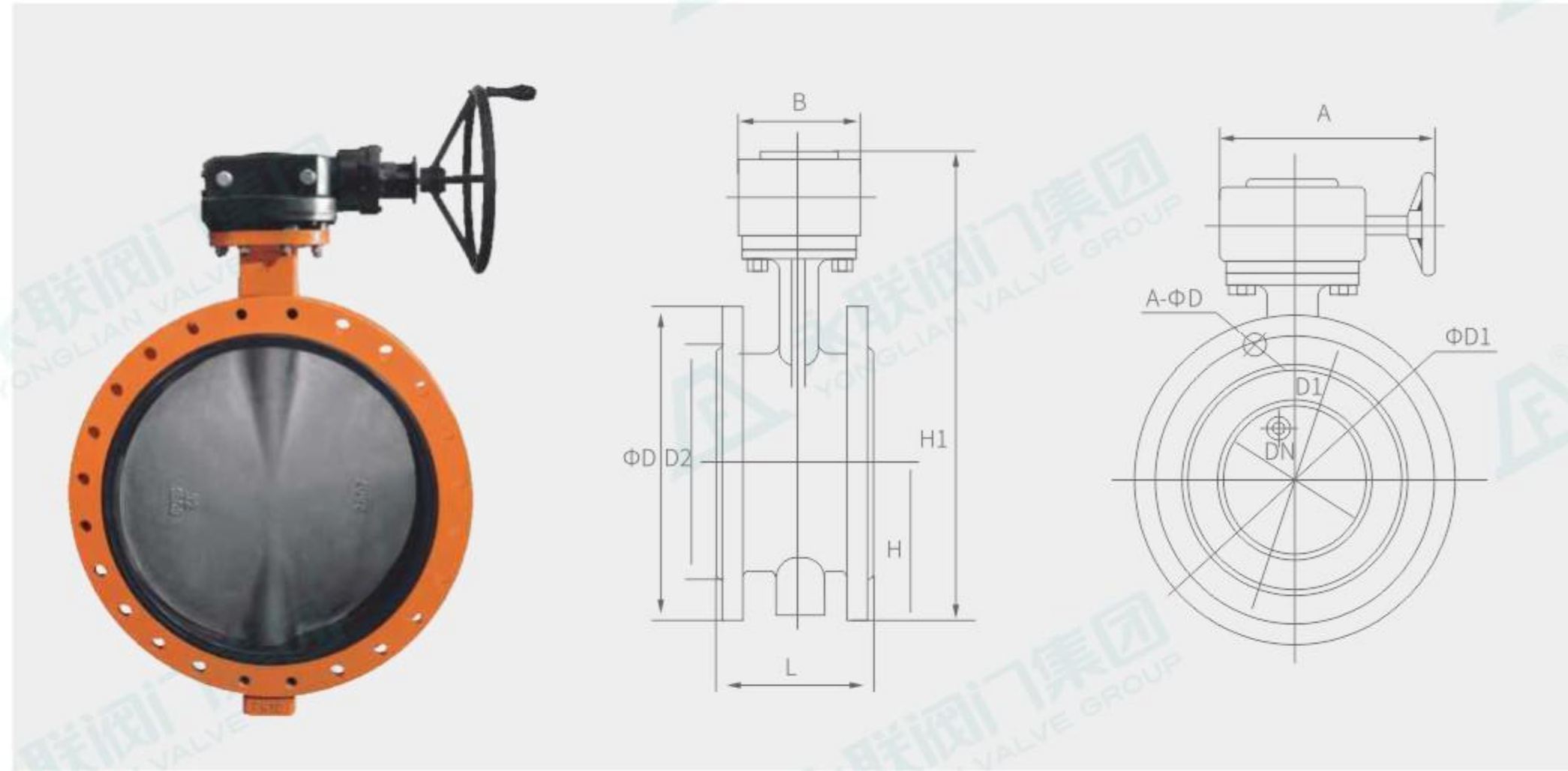
D341X - 6 (FBGX) - 16 蜗轮传动软密封蝶阀主要外形连接尺寸
